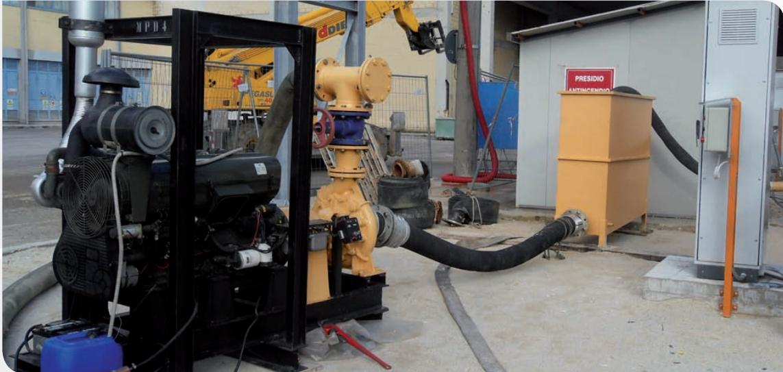
► L'attività di gestione prevede una serie di interventi per effettuare i quali **ITALCHEM** dispone oltre che di personale qualificato da una lunga esperienza nel settore, di un laboratorio di analisi olio, dotato di strumentazione specializzata, e di una serie di macchinari di varie potenzialità per interventi di flussaggio e filtrazione su ogni tipo di impianto (fino a 3000 lt/min), completi di contaparticelle automatici.
