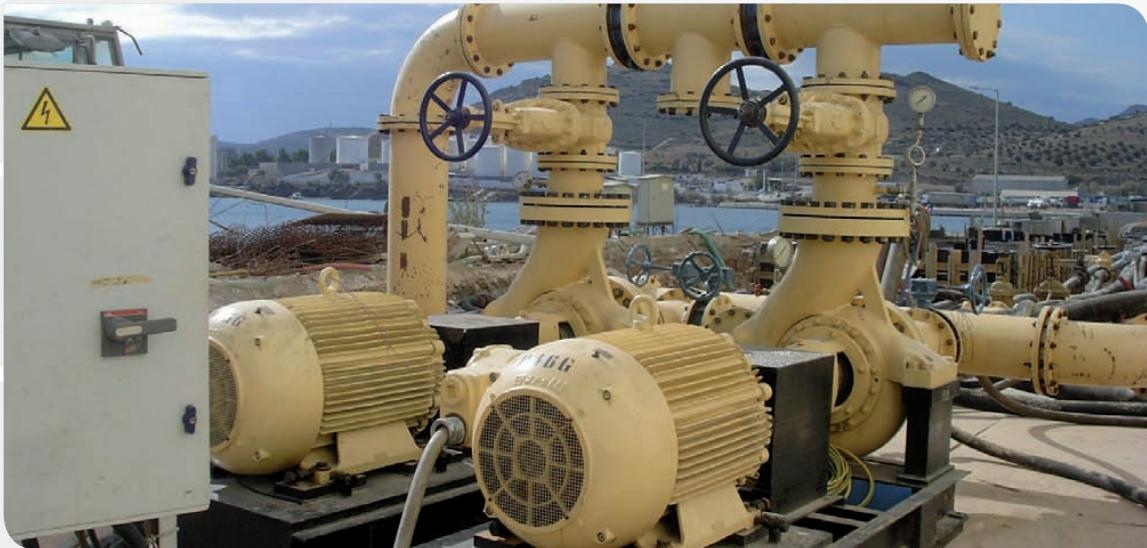
► **ITALCHEM** possiede un grande numero di pompe (gruppi pompe e singole pompe) in grado di coprire tutti i possibili utilizzi (the one more complete in Italy). In particolare dispone di più di 100 Elettropompe di varie potenzialità da 20 a 1800 m<sup>3</sup>/h comprendenti gruppi pompe di lavaggio e gruppi pompe di dosaggio tutte su skid e completi di collettori, valvole e quadri elettrici; tra cui:
